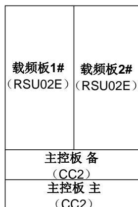
图2: BTS系统结构拓扑图
